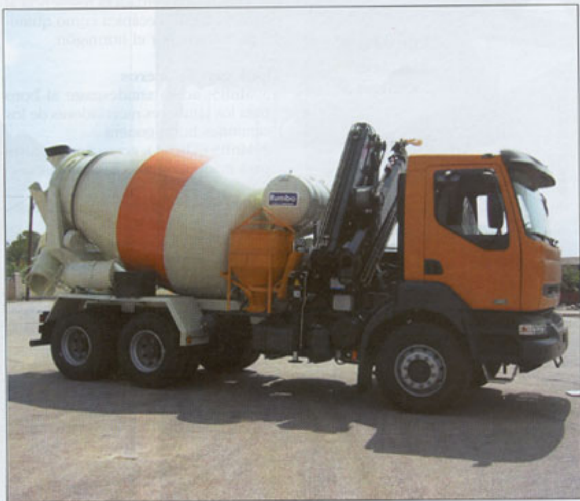
Figura 4. Equipamiento de Camión Hormigonera con Grúa.
